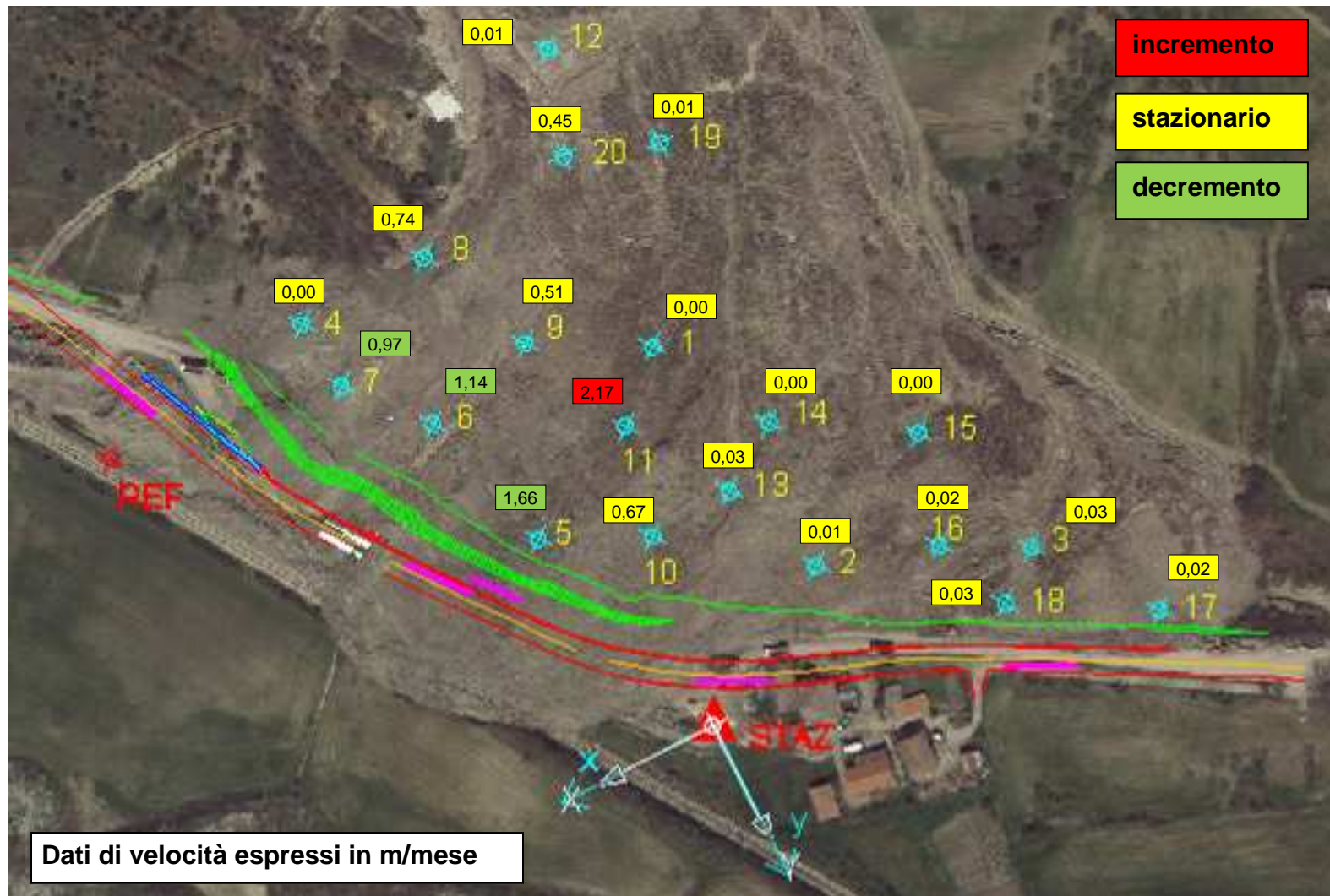
Figura 4: visione d'insieme del sistema monitoraggio attivo al piede della frana con la proiezione della viabilità provvisoria sulla foto area ante-sistemazione. Nell'immagine vengono riportati i tassi di movimento mensili (m/mese); lo sfondo delle caselle indica la tendenza: rosso – incremento; giallo – stazionario; verde - decremento.
