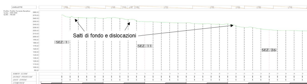
Figura 187 - Parte Nord del profilo longitudinale del Torrente Benefizio, con individuazione dei salti di fondo e delle dislocazioni.
