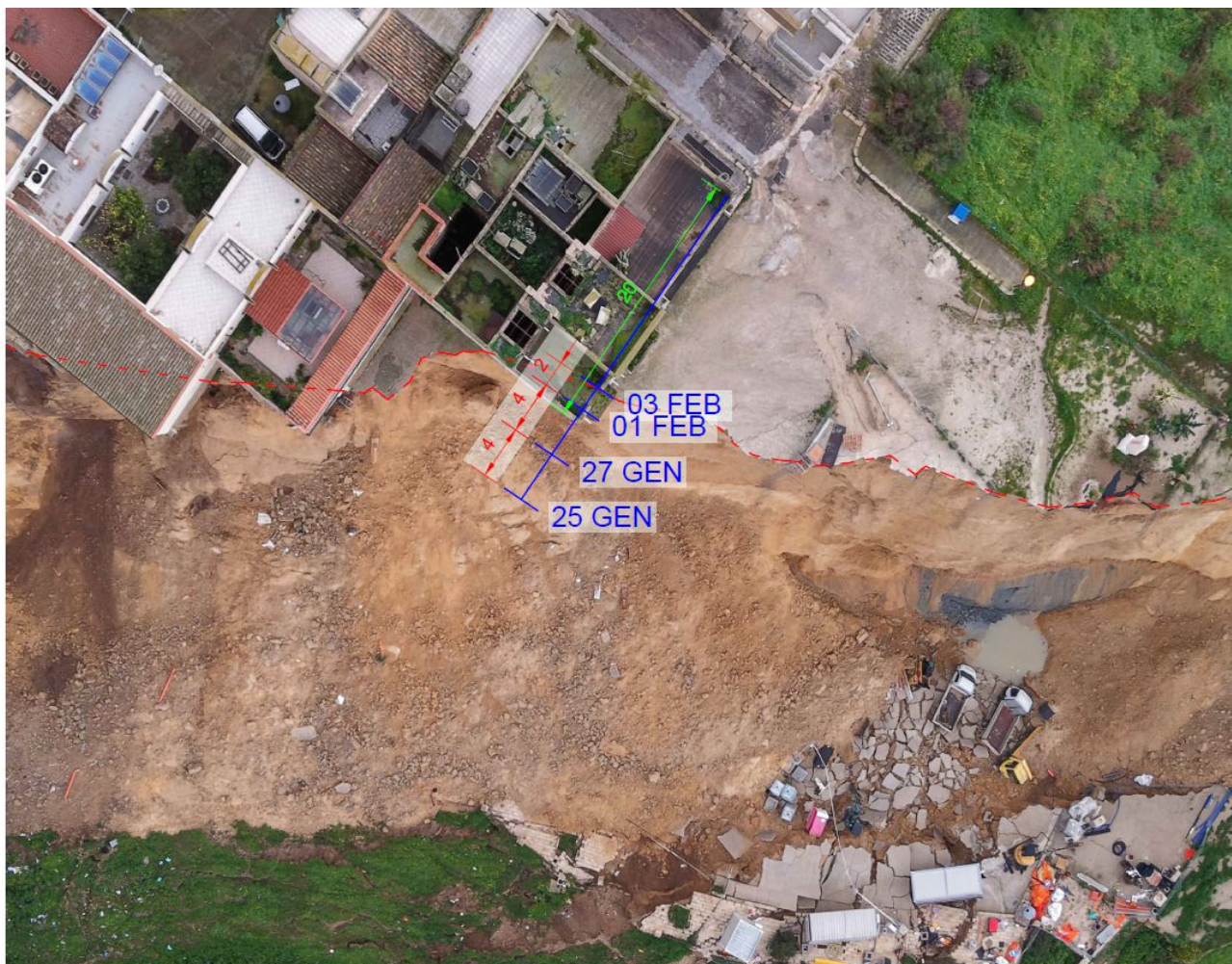
Figura 169 - Stima del tasso di arretramento (in rosso in metri) del ciglio di frana (per gentile concessione del Prof. Francesco Castelli).
