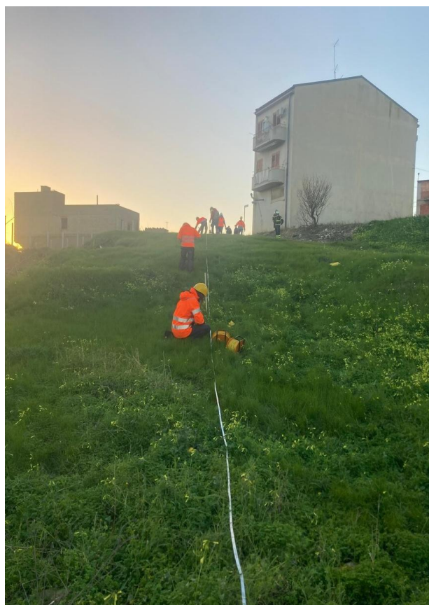
Figura 118 - Foto delle fasi di stesura della linea sismica verso NO. Per il punto di vista della foto si faccia riferimento al simbolo in Figura 117.
