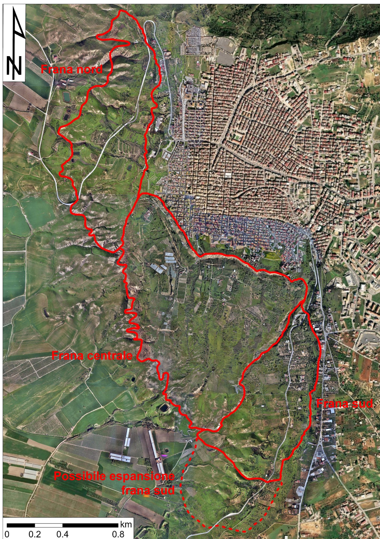
Figura 9 - Suddivisione dell'area di frana in settori cinematicamente distinti.
